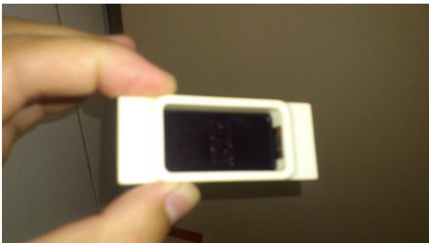
此為壓扣上蓋正面圖，明顯顯示凹陷狀況。
